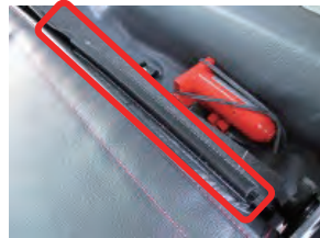
6. 座面-1で外した純正生地のプラフックを固定します。
